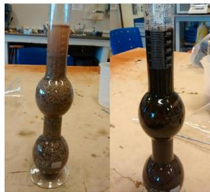
O traço, em massa, adotado para o procedimento foi de 1:4:0,65 (cimento : agregados : água), ou seja, a massa de água correspondia à 65% da massa de cimento. A distribuição de material seguiu a distribuição da tabela a seguir.
